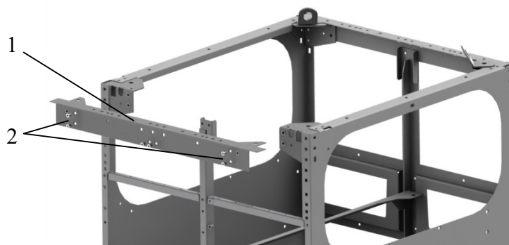
Рис. 18б. Съемная планка 1 – съемная планка; 2 – винты М6 (4 шт.)
